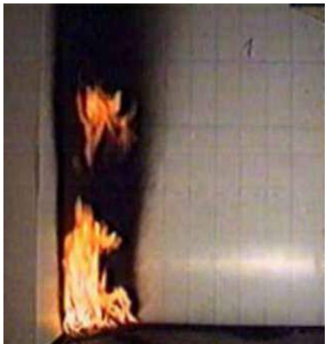
EN 13501 - PART ONE : EN ISO 1182 (NON COMBUSTIBILITY TEST)
